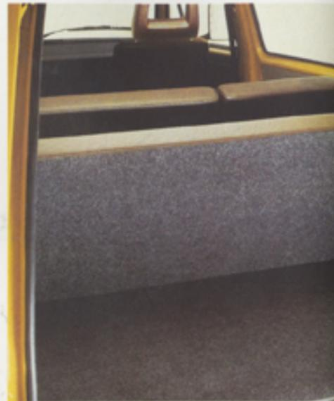
Der Gepäckraum ist bei dachhoher Beladung 1,7 m<sup>3</sup> groß. Er ist mit einem strapazierfähigem Nadelvliessteppich ausgelegt. Die Betätigung
