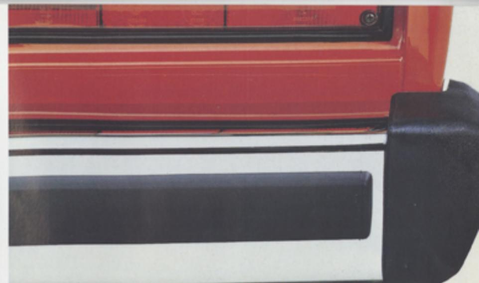
Die Stoßfänger des Caravelle CL sind aus verchromtem Stahl mit Gummistoßbleisten. Das
