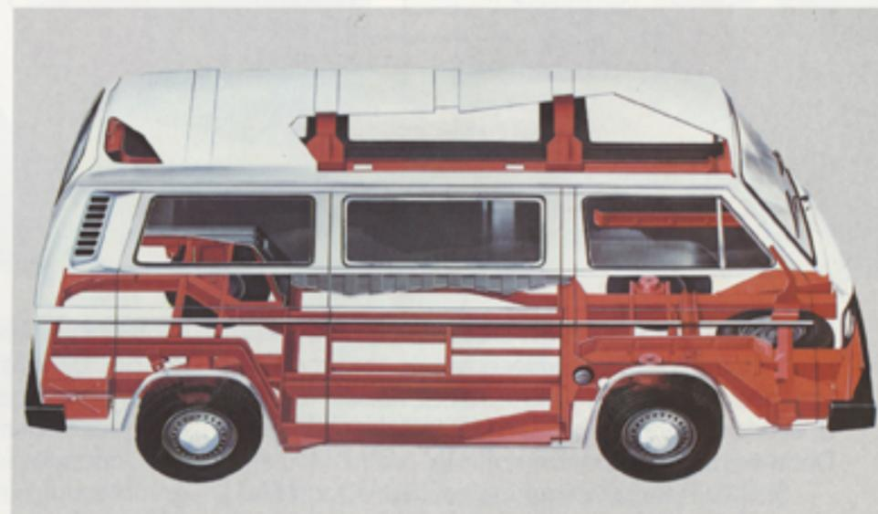
Die verformungssteife Rahmenkonstruktion der Bodengruppe gibt dem Volkswagen Caravelle hohe, passive Sicherheit. Die Aufprallenergie
